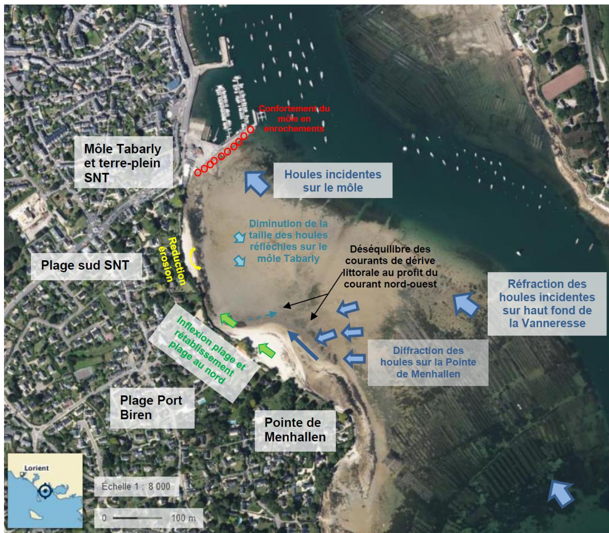
Principe de fonctionnement hydrosédimentaire futur
