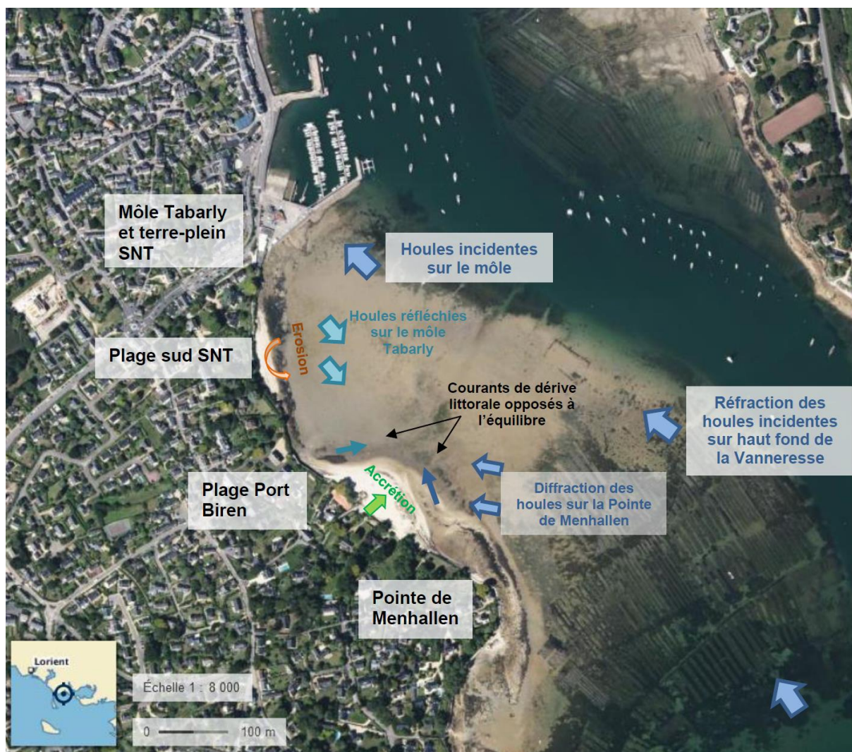
Principe de fonctionnement hydrosédimentaire actuel
